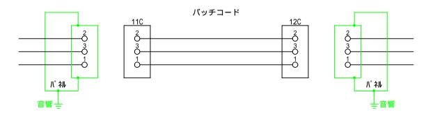
コネクタパネルは、音響専用アースに接続されています。 よって、コネクタボデーは音響アースに落ちています。 しかし、1番ピンはコネクタボデーに接続されていません。 1番ピンは、ミキサーで、回路アースに接続されます。 パッチコードは、ボデーアースされていません。(カナレ製も同じです。) しかし、パッチすると、ボデーアースがとられます。
